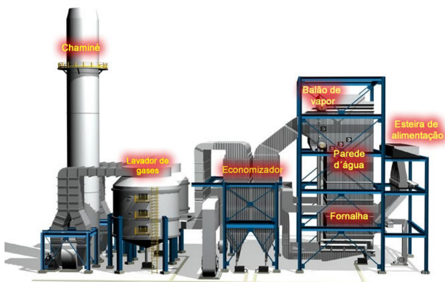
Figura 5.1 – Esquema simplificado de caldeira para biomassa. Fonte: Adaptado de BRUMAZI (2013)
